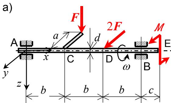
Treba provjeriti čvrstoću vratila ABCDE prema energijskoj teoriji čvrstoće HMH, ako ono prenosi snagu  $P = 45 \text{ kW}$  kod brzine vrtnje  $n = 12 \text{ s}^{-1}$ .
